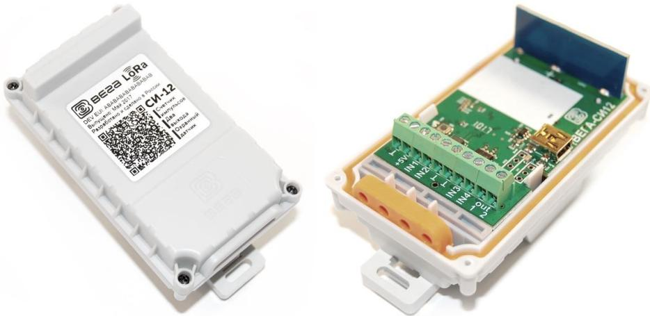
Элементом питания для счетчика служит встроенная батарея ёмкостью 3400 mAh, рассчитанная на срок службы до 10 лет при передаче данных один раз в сутки. Также счетчик может работать от внешнего источника питания с напряжением 5 В.
